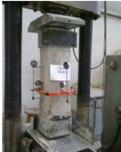
الشكل (7) تجربة التحميل على العينة SJ-0-1
