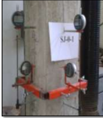
الشكل (3) توضع مقياس الانتقال الطولية والجانبية للعيونة SJ-0-1
